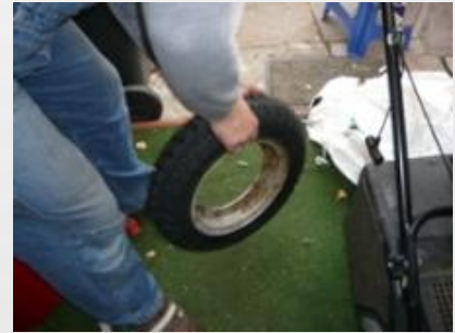
Den gefüllten Reifen ein paar mal auf den Boden springen lassen und dabei immer ein Stück weiterdrehen um eine andere Stelle aufsetzen zu lassen. Das sollte man machen damit er sich auch wirklich überall gesetzt hat.
