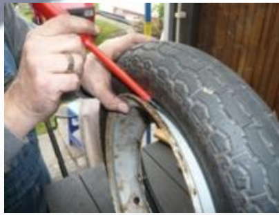
Mit einem kleinen Brecheisen oder dem stumpfen Schraubendreher die Reifenwand von dem Felgenrand drücken. Achtung: Verletzungsgefahr durch abrutschen mit dem Werkzeug.
