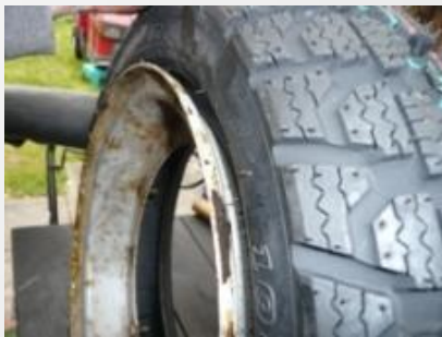
Kontrolle auf einigermaßen gleichen Sitz der Felgenhälfte.
