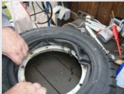
In den halb montierten Reifen etwas Talkumpuder einfüllen und im Reifen gleichmäßig durch drehen verteilen. Info: das Talkumpuder soll später Reibungen vermeiden.
