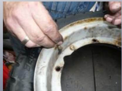
Das Ventil des Schlauches in die Ventilöffnung der Felge einziehen. Vorsicht nicht verdrehen.
