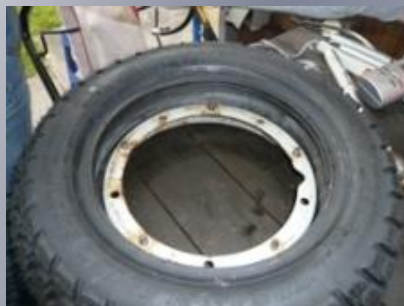
Reifen flach hinlegen und Schlauch noch mal in den Reifen nachdrücken.
