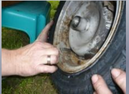
Das Rad wieder aufstecken und die M8er Muttern und Federringe anhängen und beidrehen. Achtung: Immer in Sternform beidrehen um ein verkanten zu vermeiden.
