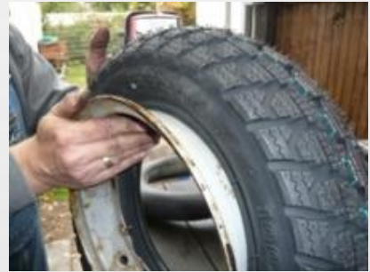
Den Reifenrand mit Reifenfett oder Haarschampoo einschmieren und auf die Felgenhälfte aufdrücken. Achtung: Durch das Fett oder Shampoo erhöhte Unfallgefahr. Schmierig/Rutschig!
