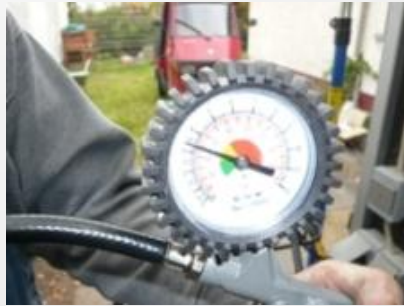
Drei bis vier Bar sind vollkommen ausreichend, damit sich der Reifen ordentlich in den Felgenrand setzt.
