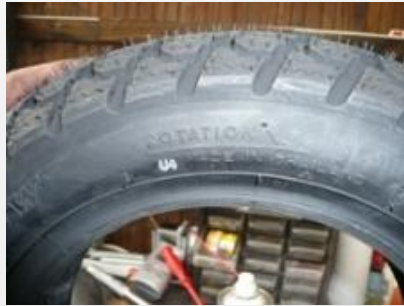
Den neuen Reifen vor dem aufziehen auf Beschädigungen prüfen und die Laufrichtung feststellen. Die Laufrichtung des Reifens wird mit einem Pfeil auf der Seite angegeben (Rotation) und der muss immer in Fahrrichtung zeigen bzw. montiert werden.
