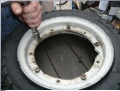
Alle M8er Muttern und Federringe montieren und festziehen. Achtung: Nach fest kommt ab! Also die Muttern nicht zu extrem anziehen.
