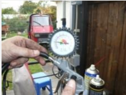
Den richtigen Reifendruck anpassen. In unserem Fall 2,5 Bar.
