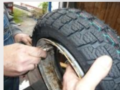
Mit einem Ventilzieher evtl. den Schlauch noch mal nachziehen.
