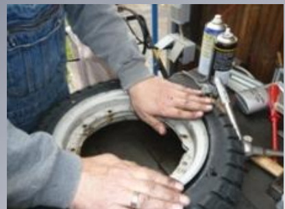
Zweite Felgenhälfte auf den Reifen montieren. Hierbei größte Vorsicht walten lassen, denn der Schlauch kann zwischen den beiden Felgenhälften eingequetscht und dadurch verletzt werden.
