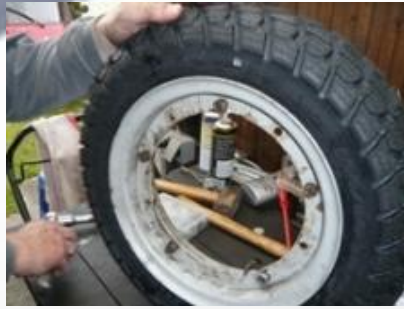
Die beiden Felgenhälften auf korrekten Sitz kontrollieren.
