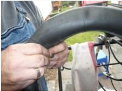
In den zuvor entnommenen Schlauch das Ventil wieder eindrehen und festziehen. Danach ein wenig Luft in den Schlauch einfüllen.
