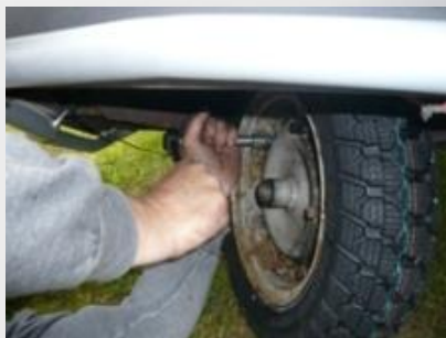
Das beidrehte Rad festziehen. Achtung: Nach fest kommt ab!
