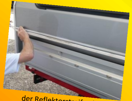
der Reflektorstreifen ist angebracht
