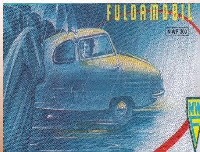
Fuldamobil "NWF 200" Das Fuldamobil "NWF 200" wurde in der Zeit von 1954-1955 gebaut. Es hatte einen 1 Zylinder 2-Taktmotor mit 197 ccm und 9,5 PS Leistung. Insgesamt wurden ca. 700 Stück von diesem Typ gebaut.
