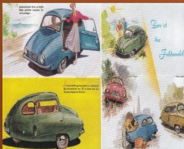
Fuldamobil "NWF 200" Der Motor war vor dem einzelnen Hinterrad montiert. Antriebsart "Kette". Die Höchstgeschwindigkeit lag bei 80 Km/h.
