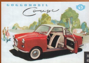
Goggomobil Coupe TS Das Goggomobil wurde von 1955-1969 gebaut. Es hatte einen 2 Zylinder 2-Taktmotor bis 250 ccm. Von der Coupe TS Version wurden ca. 66.511 Stück gebaut.
